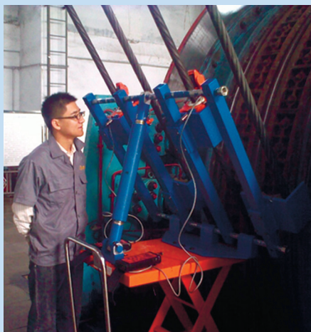
Рис. 2. Проведение одновременного контроля двух канатов.
