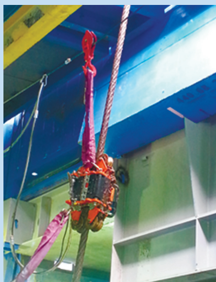
Рис. 4. Применение дефектоскопа «ИНТРОС-АВТО» для мониторинга состояния талевого каната буровой установки.
